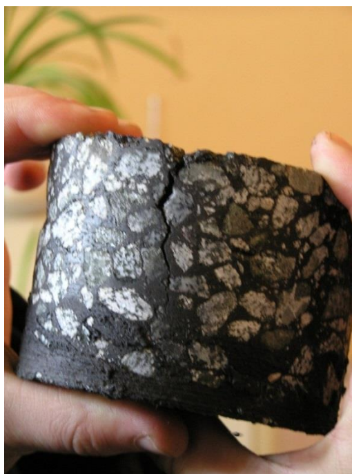
Рис. 22. Керн, взятый из дорожной одежды
