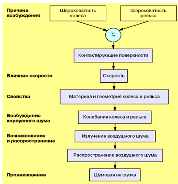
Рисунок 2. Взаимосвязь факторов, приводящих к образованию шума качения колес
