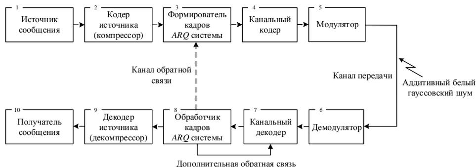
**Рисунок 1.** Структурная схема системы передачи информации с применением дополнительной обратной связи между каскадами обработки (рисунок разработан авторами на основе материалов [5, 6])
