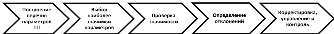
Рисунок 1. Методический подход к функционированию автоматизированной системы контроля и управления линий по производству продуктов (составлено автором)
