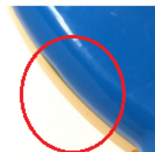
Рисунок 6. Дефект «неравномерные линейные размеры деталей»
