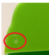
Рисунок 9. Дефект «след от пресс-формы»
