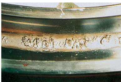
Рисунок 3. Износ наружного кольца, (фото NTN)
