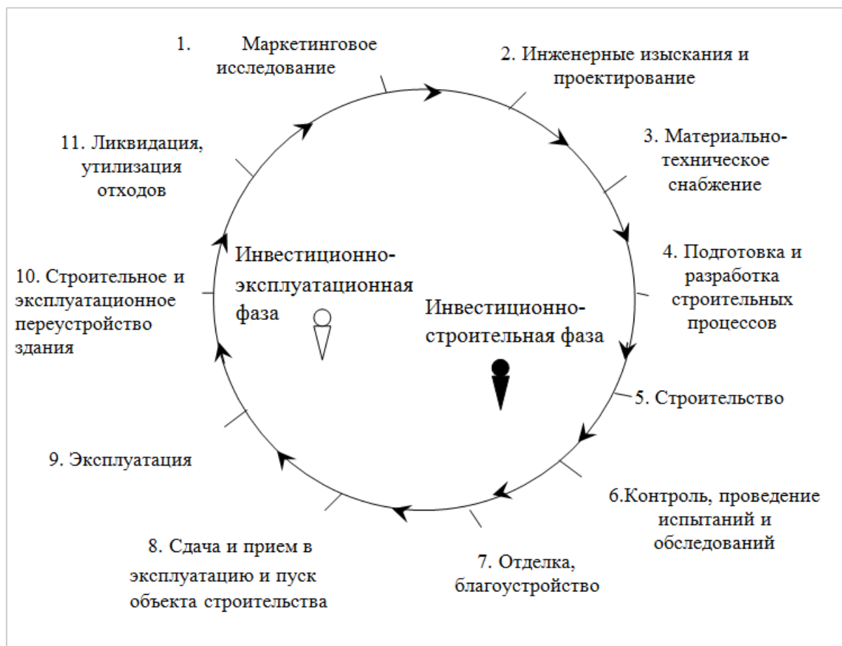
Рисунок 1. Схема «петли качества» для строительного объекта
