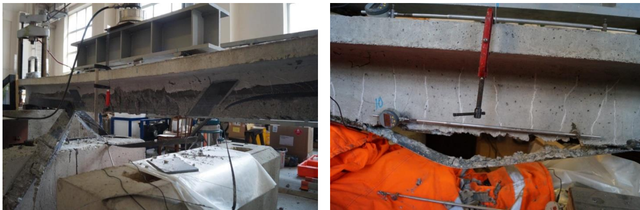
Рис. 7. Фотографии разрушенных моделей типовой балки
