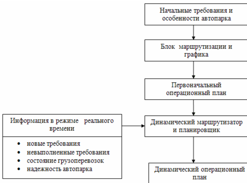
Рис. 2. Концептуальная схема оценки систем управления автопарком в режиме реального времени
