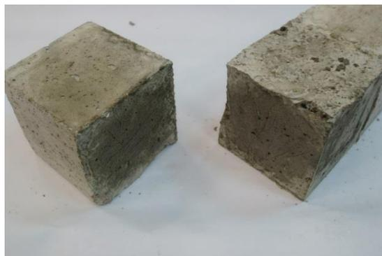
в) разрушение по контакту «легкий бетон – тяжелый бетон» - схема 3 в табл. 2
