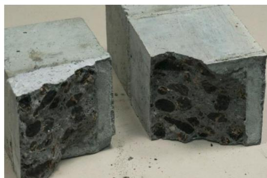
*б) разрушение по легкому бетону и контакту «легкий бетон – тяжелый бетон» - схема 2 в табл. 2*
