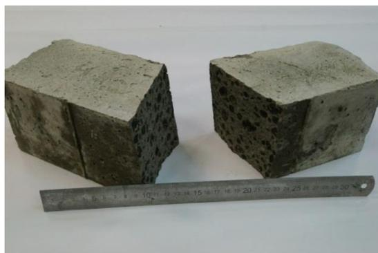
*а) разрушение по легкому бетону (разрушение от изгиба) – схема 1 в табл. 2*
