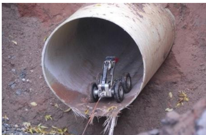
Рисунок 3. Обследование роботом внутреннего состояния трубы выполнено, показатели диагностики зафиксированы (источник: http://gidroluch-samara.ru )
