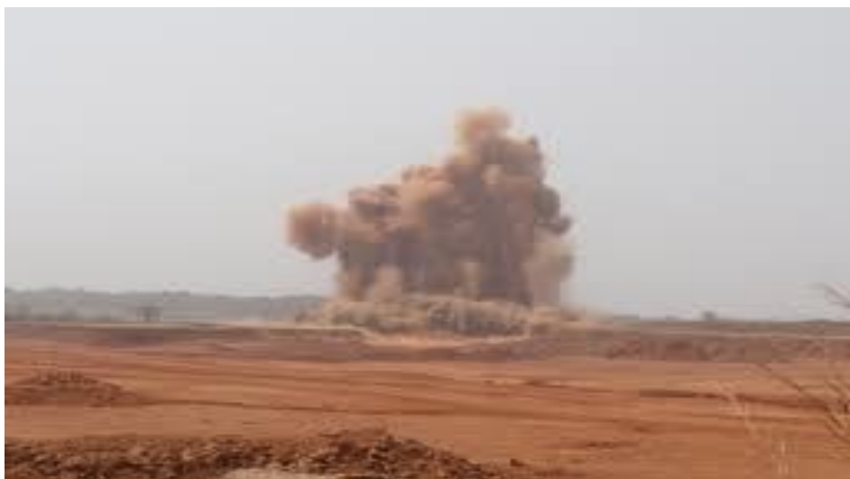
Рисунок 1. Выбросы в атмосферу вредных химических веществ и пыли при буровзрывных работах на карьере [2]
