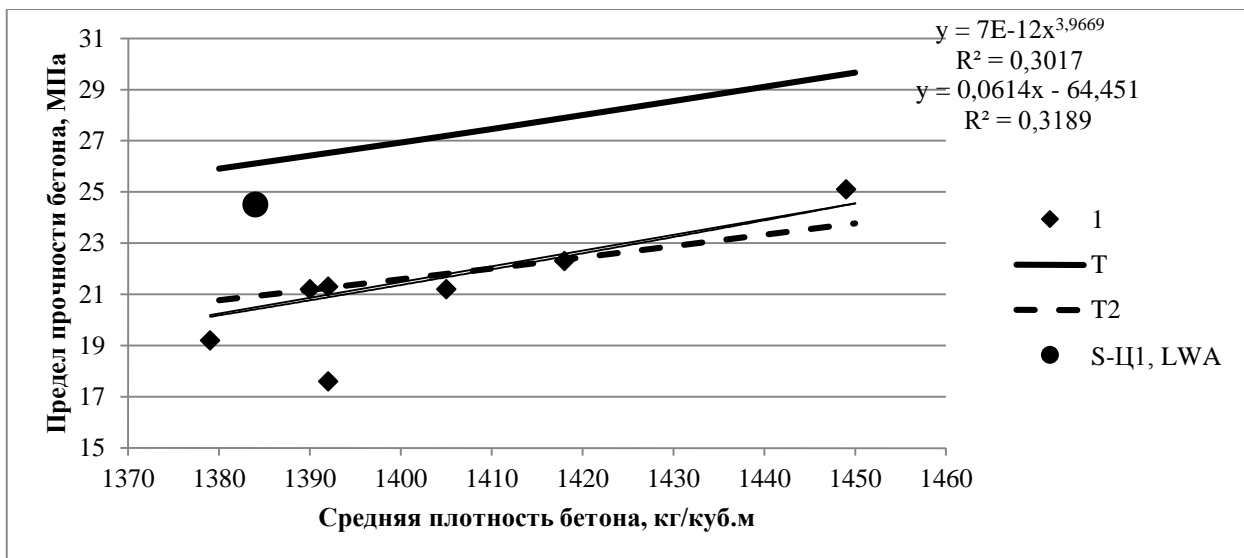
Рисунок 3. Зависимость предела прочности на сжатие керамзитобетона от средней плотности 1, S-Ц1, LWA – по экспериментальным данным; T – по формуле
