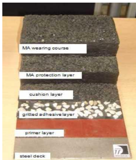
Рис. 24. Тип 1: водонепроницаемый слой на основе изоляционной смолы
