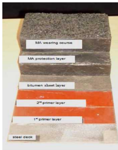
Рис. 25. Тип 3: водонепроницаемый слой на основе смолы/битума
