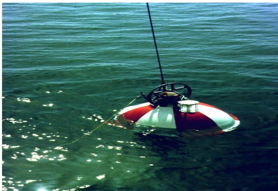
*Рисунок 5. ГДАС серии «Монитор» с комплектом гидрофизических датчиков после всплытия на поверхность моря*
