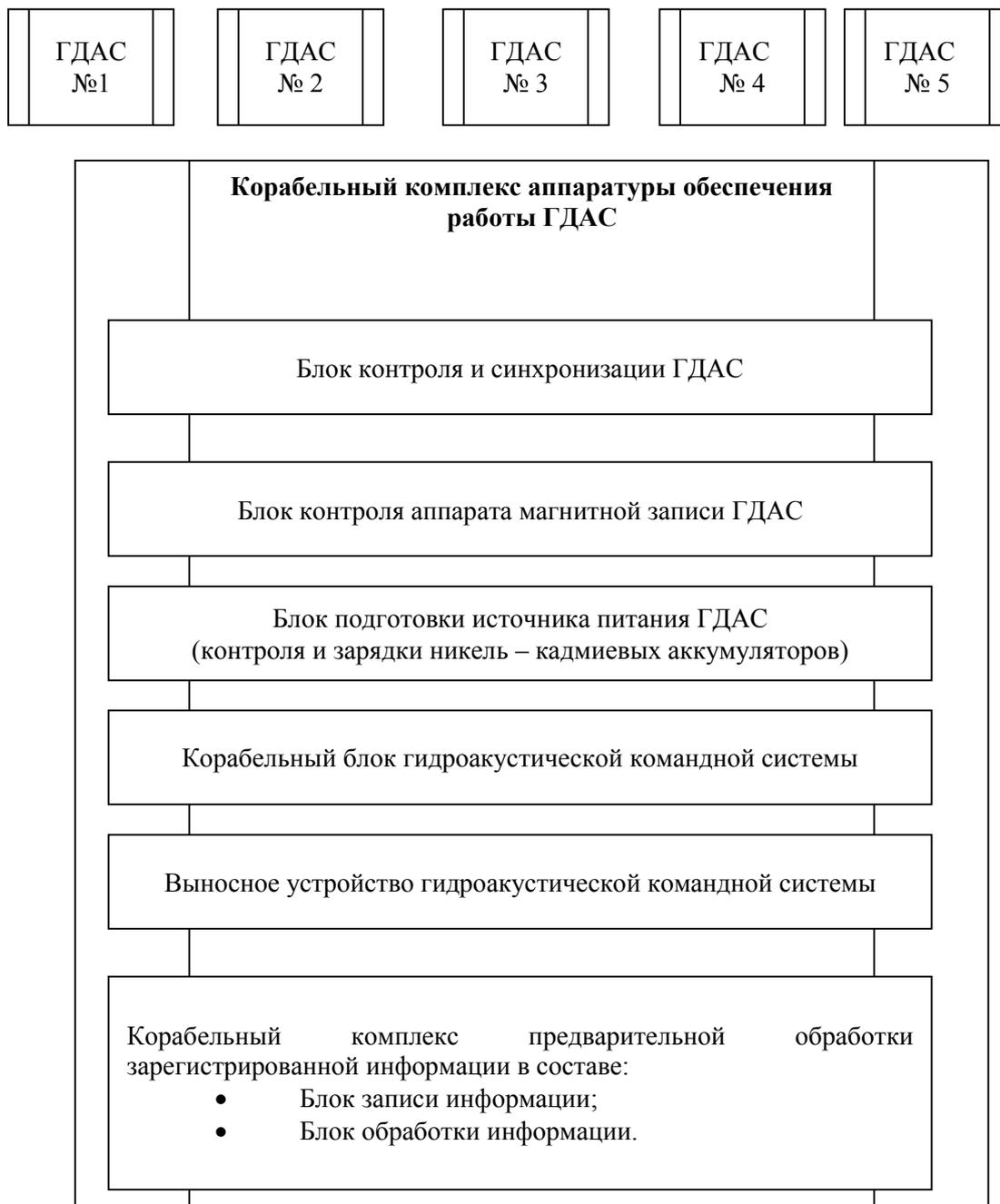
*Рисунок 2. Состав комплекса глубоководных донных станций (ГДАС) серии «Монитор»*
