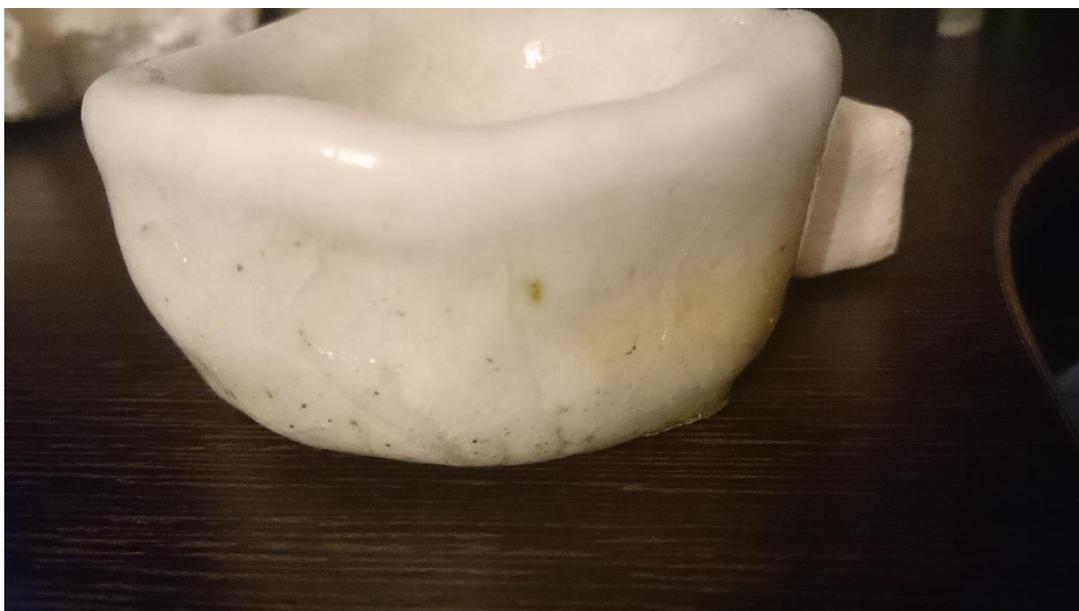
*Рисунок 3. Состав №6 после обжига при 1000°C° (составлено автором)*
