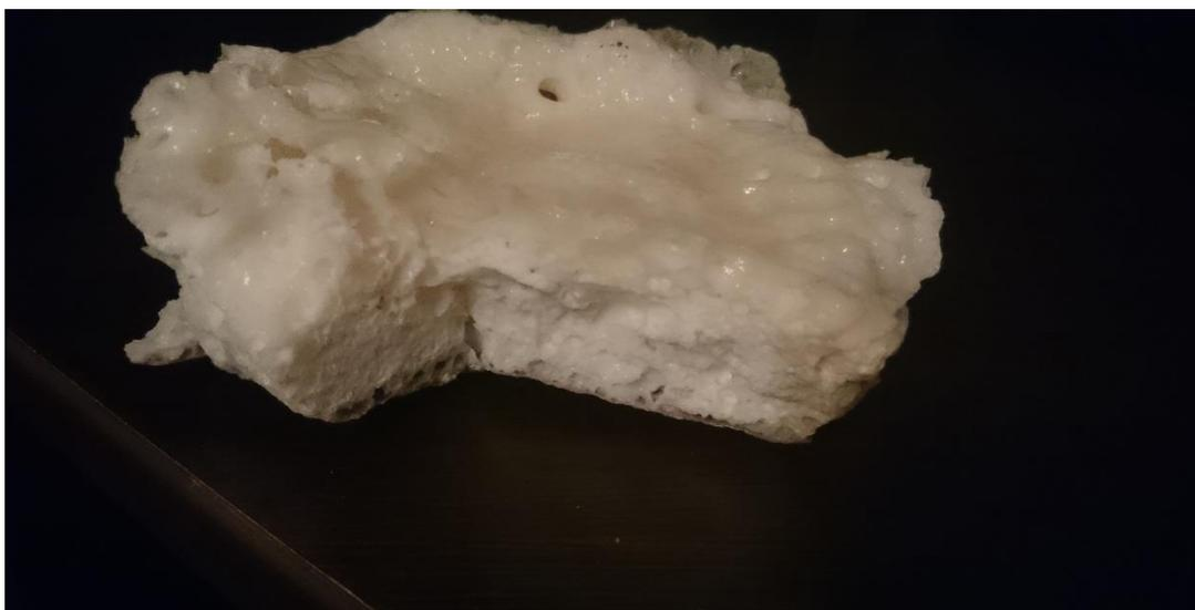
*Рисунок 4. Состав №12 после обжига при 1300°C (составлено автором)*
