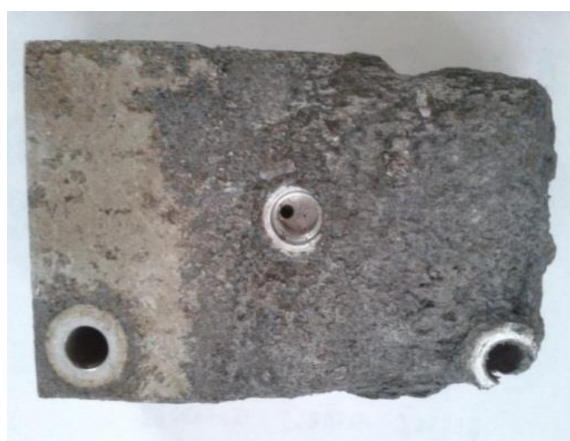
Рисунок 3. Клапан управления перемещением бурового станка СММ-2А, вышедший из строя в результате воздействия агрессивной среды (фото авторов)
