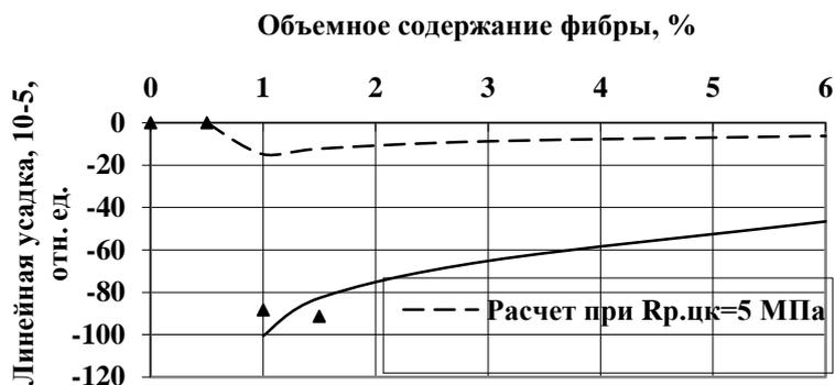
**Рисунок 9.** Зависимость расчетной и экспериментальной линейной усадки при твердении сталефибробетона с фиброй ФСП-А 30х0.3 от объемного содержания фибры при  $C_f < d_{cp}$  и  $C_f \approx D$  (составлено/разработано автором)
