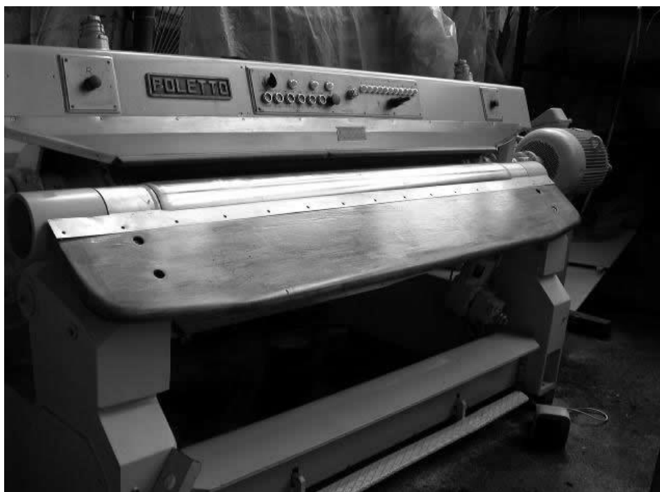
Рисунок 1. Заточной аппарат строгальной машины RLA(Rizzi)
