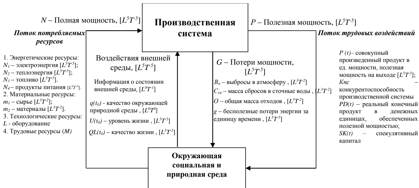
Рисунок 2. Схема показателей производственной системы на основе универсальных системных мер (составлено авторами)
