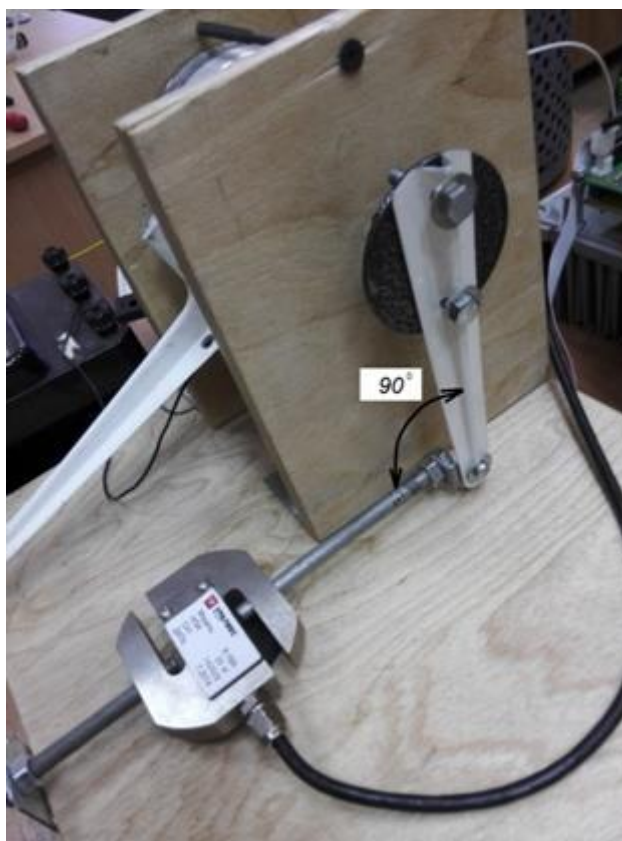
Рисунок 3. Положение установки тензодатчика (составлено автором)
