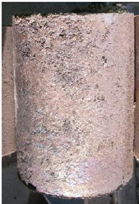
**Рисунок 1.** Отливка из бронзы, полученная литьем в кокиль (разработано автором)
