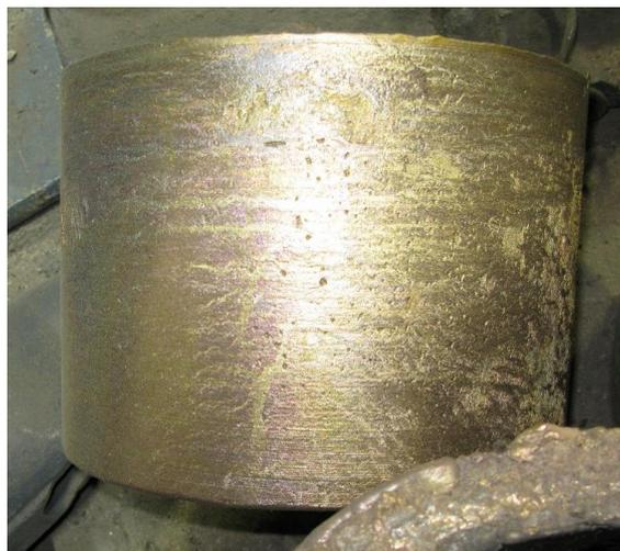
*Рисунок 5. Отливка из бронзы без шлаковых включений (разработано автором)*
