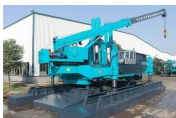
*Рисунок 2. СВУ шагающего типа*
