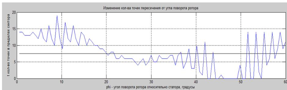
**Рисунок 2.** Зависимость количества контактов ножевых кромок  $t$  от угла поворота ротора относительно статора
