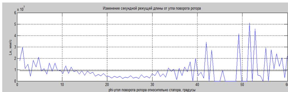
Рисунок 1. Зависимость секундной режущей длины  $L_s$  от угла поворота ротора относительно статора
