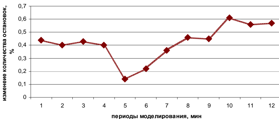
Рис. 4. Относительное уменьшение количества остановок в случае быстрого характера роста очереди транспортных средств при установлении оптимизированной схемы организации дорожного движения
