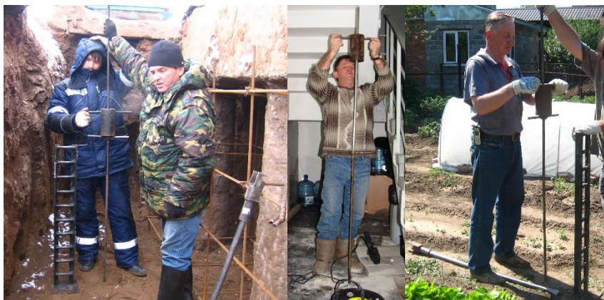
Рисунок 1. Примеры реализации динамического зондирования грунтового основания с применением средств малой механизации на различных объектах (источник: разработано автором)
