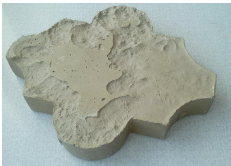
Рисунок 3. Фотография серобетонной тротуарной плитки снизу (фото авторов)
