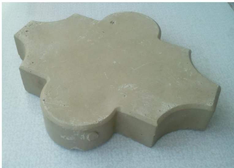
Рисунок 2. Фотография серобетонной тротуарной плитки сверху (фото авторов)
