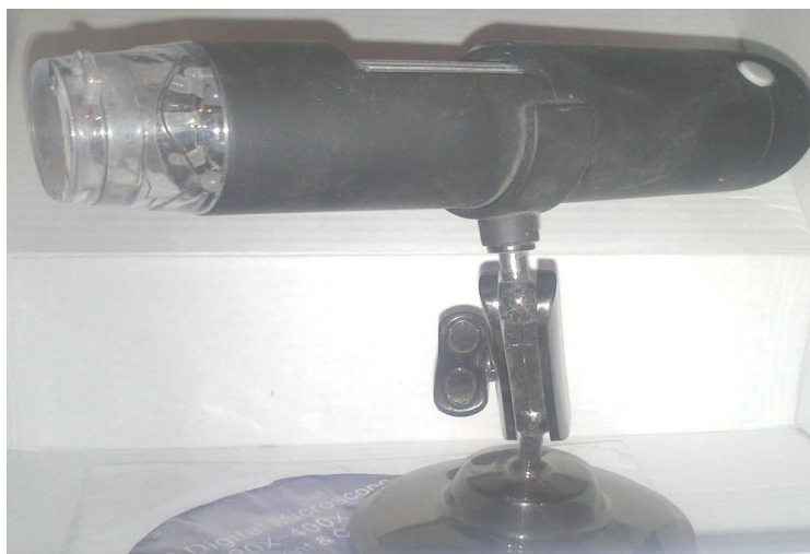
Рисунок 1. Цифровой микроскоп с 200-кратным увеличением (фото авторов)
