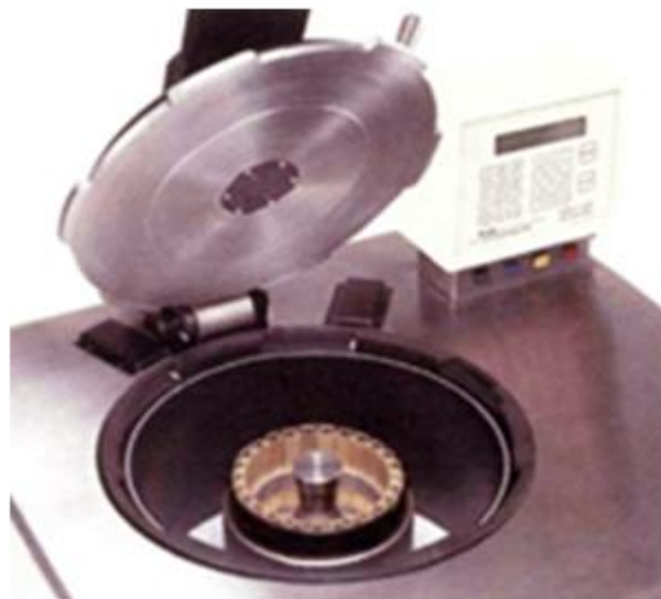
Рис. 3. Центрифуга 9050 фирмы WebTechnology (США) с микропроцессорным управлением и программированием режимов
