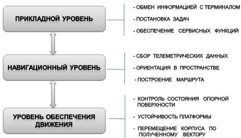
Рисунок 7. Структура системы управления ШР Гексабот (разработано авторами)
