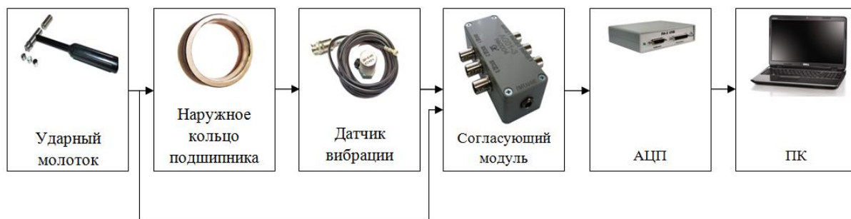
Рис. 1. Структурная схема системы исследования частотных характеристик с помощью импульсного воздействия
