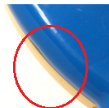
Рисунок 6. Дефект «неравномерные линейные размеры деталей»
