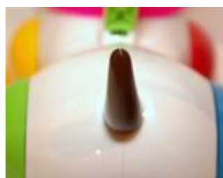
Рисунок 10. Дефект «травмоопасные выступающие детали»
