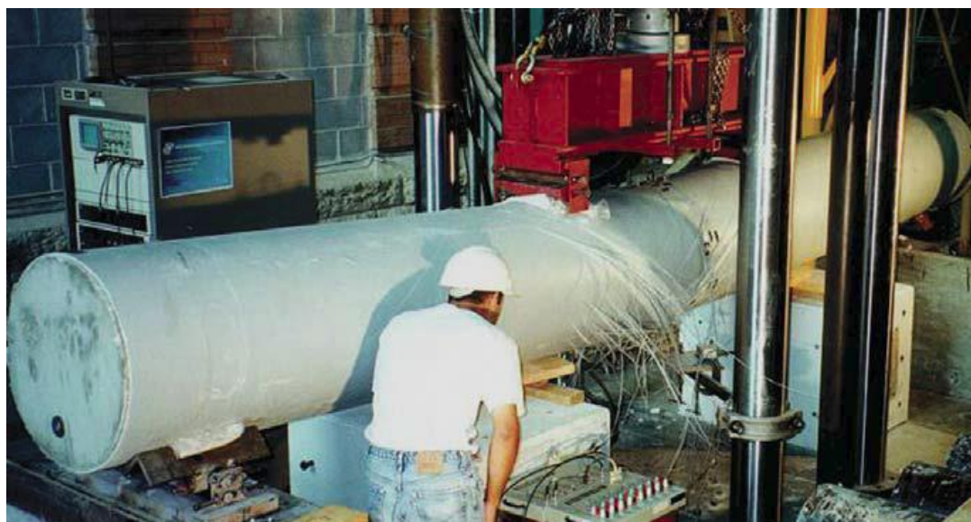
Рис. 8. Испытательная установка для испытаний трубобетонного образца на изгиб [10]
