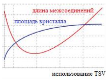
Рис .1. Площадь кристалла и длина межсоединений при использовании TSV
