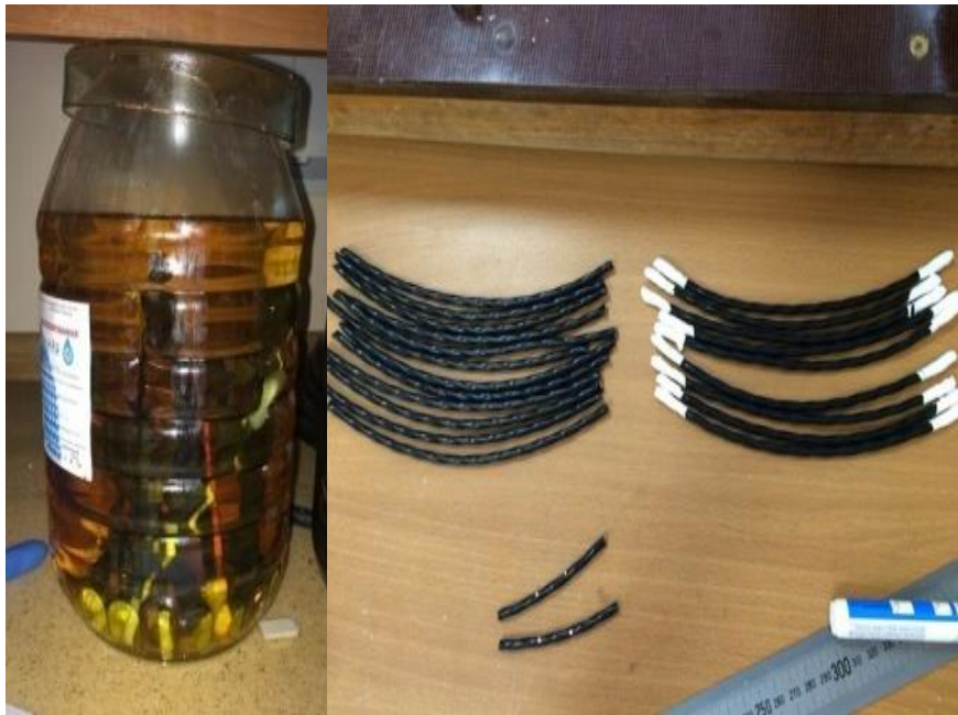
Рисунок 4. Общий вид образцов при проведении испытаний на маслостойкость (разработано автором)
