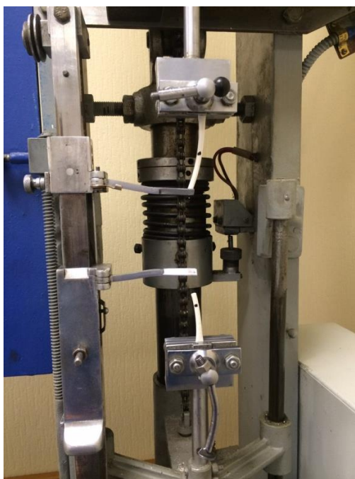
Рисунок 2. Разрывная машина марки РМИ - для определения изменения физико-механических характеристик (разработано автором)
