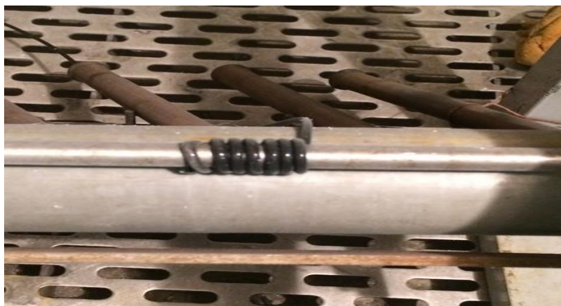
Рисунок 1. Общий вид образца на установке для испытания на монтажный изгиб (разработано автором)
