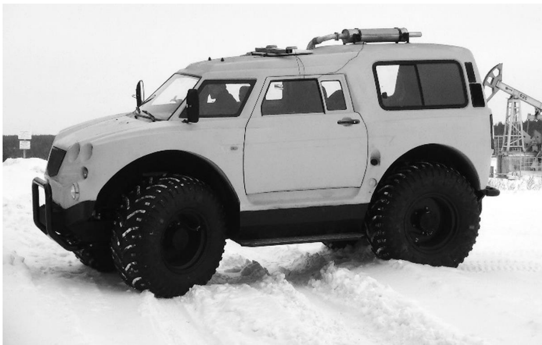
Рисунок 2. Вездеход Русак 3992 на шинах сверхнизкого давления (фото авторов)
