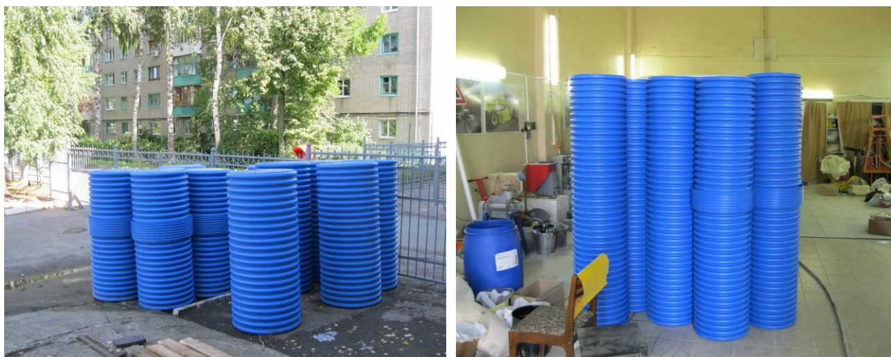
Рисунок 1. Образцы двухслойных гофрированных труб номинальным внутренним диаметром DN/ID 400 мм и 800 мм (сделан автором)
