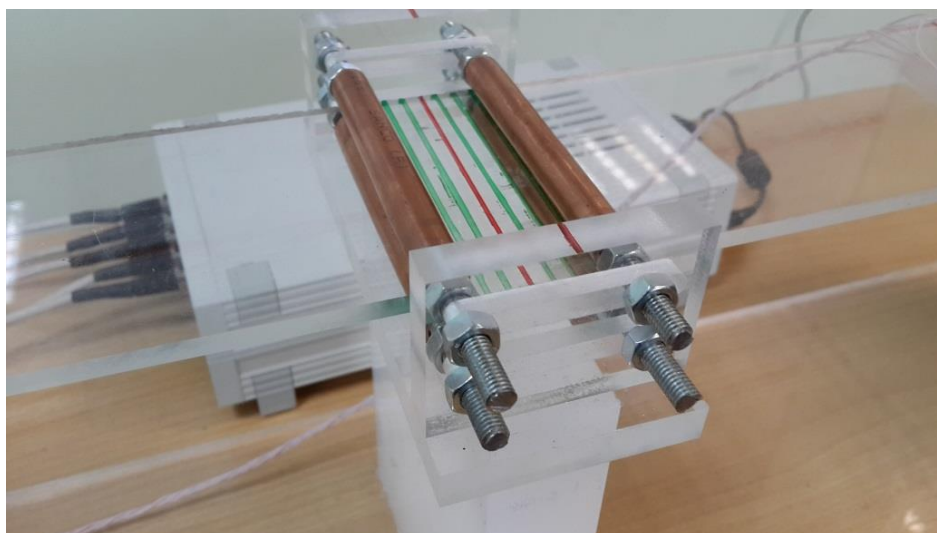
Рис. 5. Промежуточная опора с двумя опорными частями
