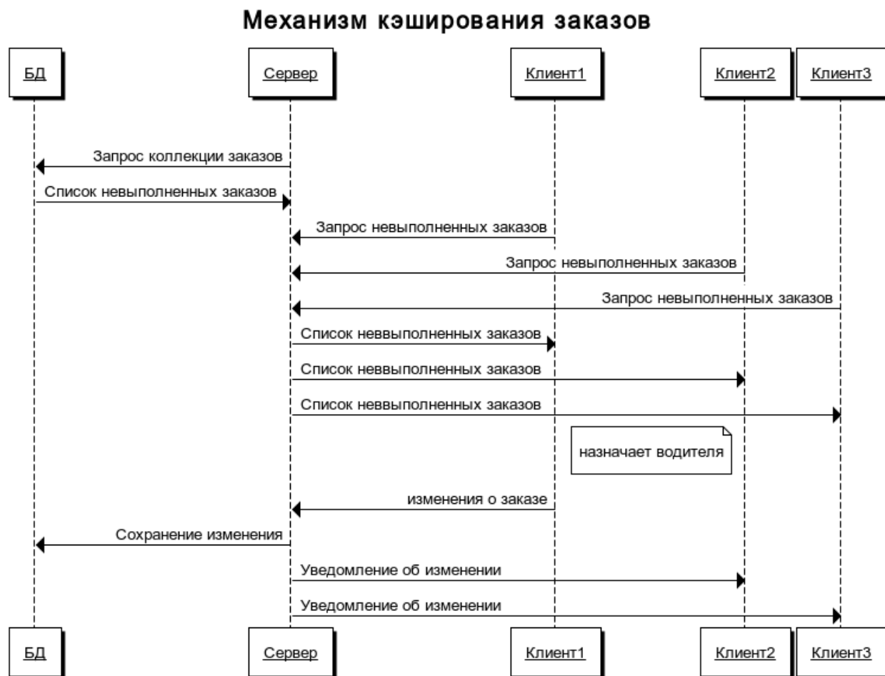
Рис. 4. Диаграмма последовательностей кэширования заказов
