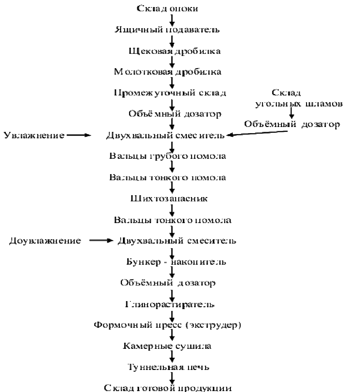
Рис. 4. Технологическая схема производства пористо-пустотелых изделий керамических изделий на основе опок и отходов углеобогащения
