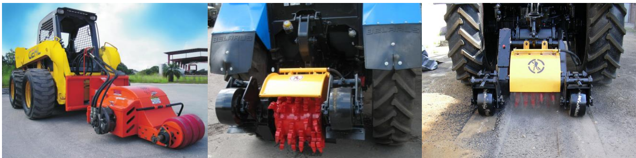
Рисунок 1. Фрезы для устройства шумовых полос (разработано авторами)
