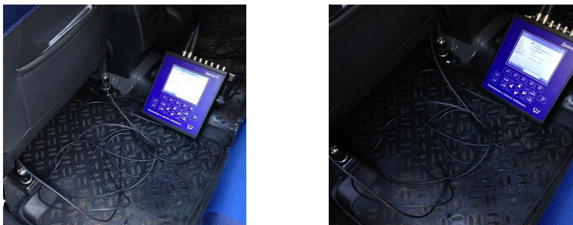
Рисунок 2. Установка датчиков в салоне АТС (разработано авторами)
