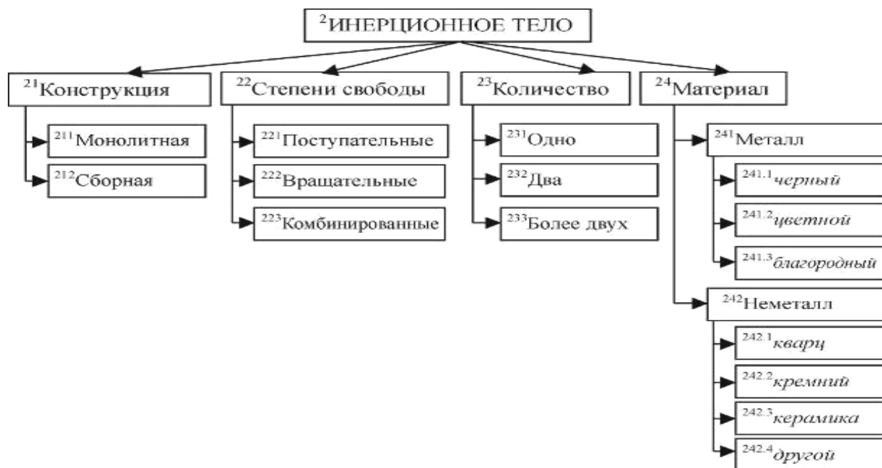
Рис. 2. Схемы ММГ с различными видами движений
