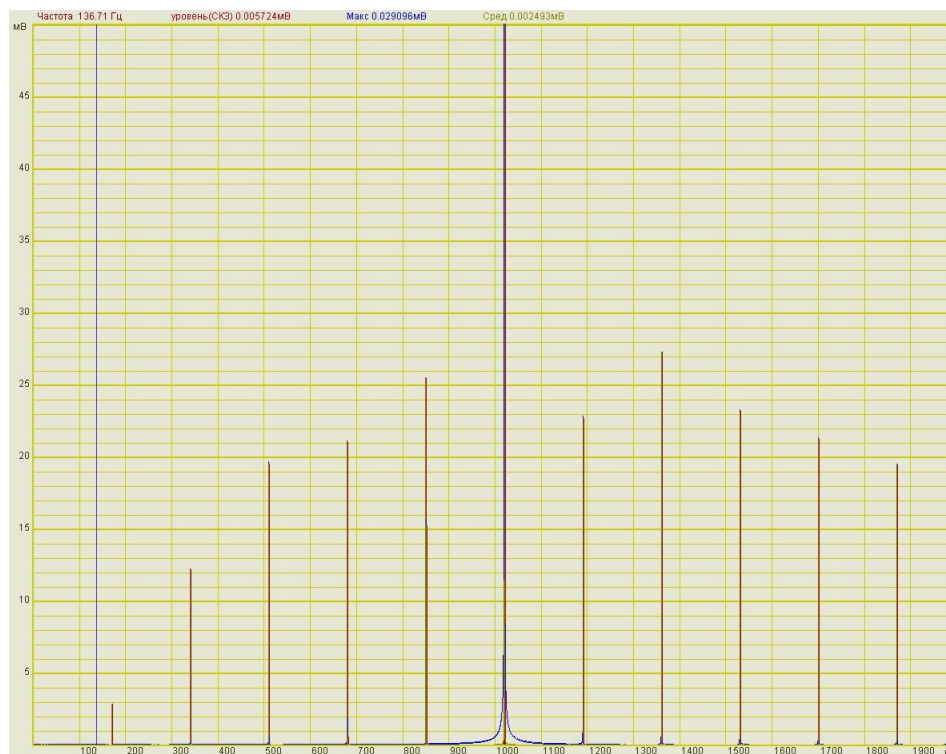
Рис. 2. Спектр сигнала с датчика оборотов, полученный с ZET017
