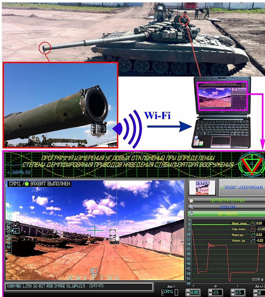
Рисунок 5. Экспериментальная проверка программы измерения угловых отклонений стабилизатора вооружения и её интерфейс (сделано автором Зубарь А.В.)
