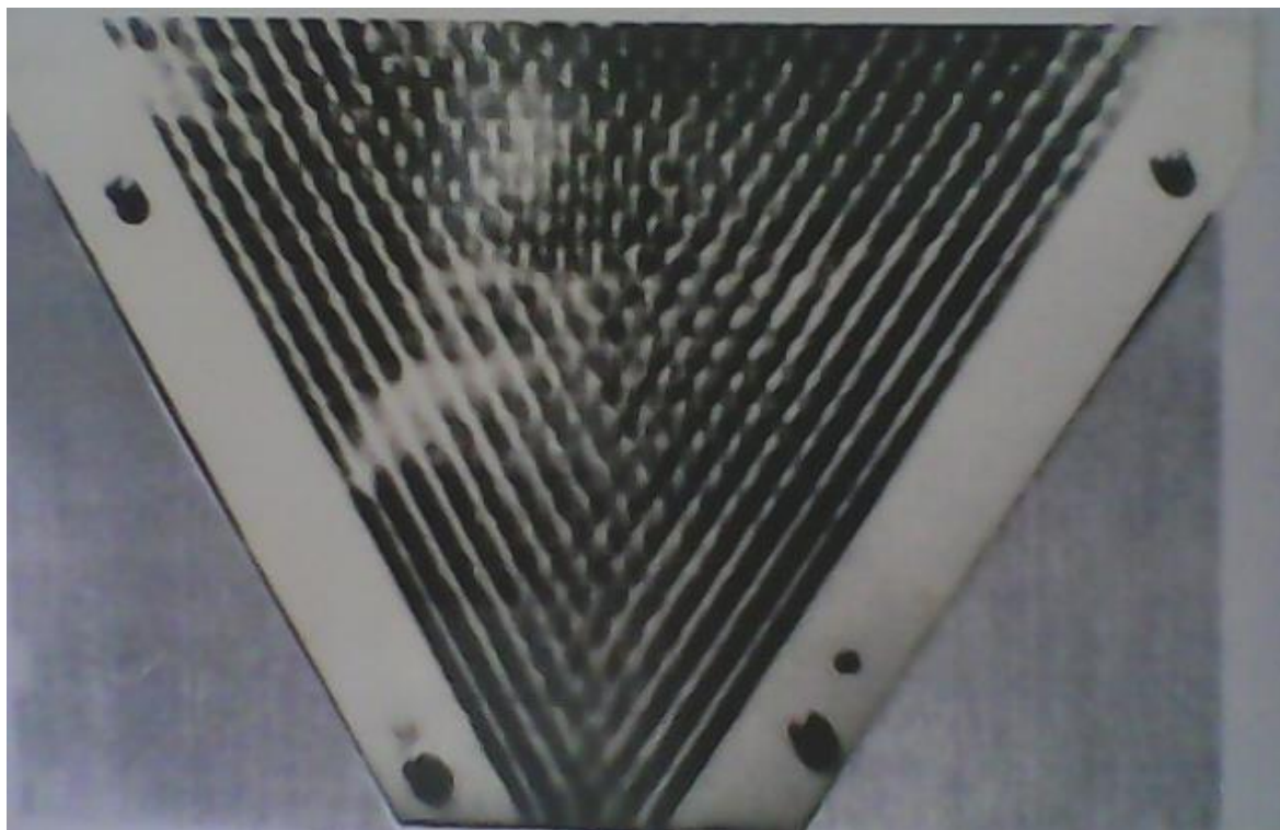
Рис. 2. Действительные линии скольжения реальных частиц сыпучего тела в бункере (движение стальных шариков) [1]
