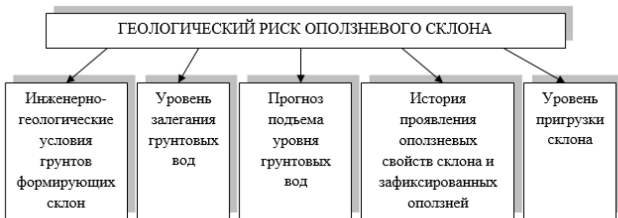
Рис. 2. Факторы, составляющие прогнозирование геологического риска на оползневых склонах
