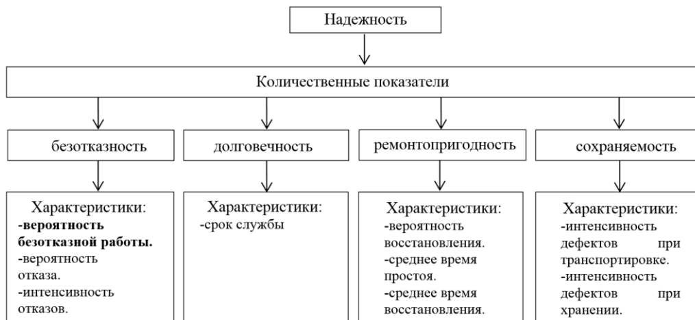
Рисунок 4. Структура показателей свойства надежности разводных мостов (составлен авторами)
