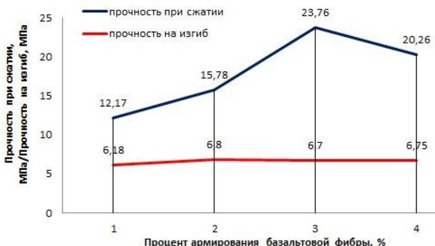
Рисунок 3. Зависимость прочности бетона на сжатие и изгиб от содержания базальтовой фибры (разработано авторами)
