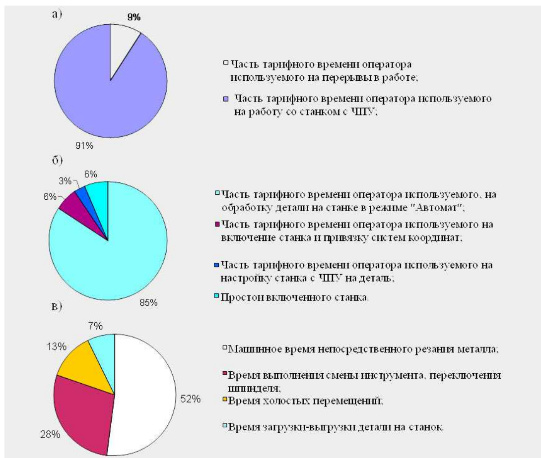
Рис. 1. Диаграммы оценки потраченного времени в ходе обработки корпусной детали на токарно-револьверном станке с ЧПУ Haas SF20
