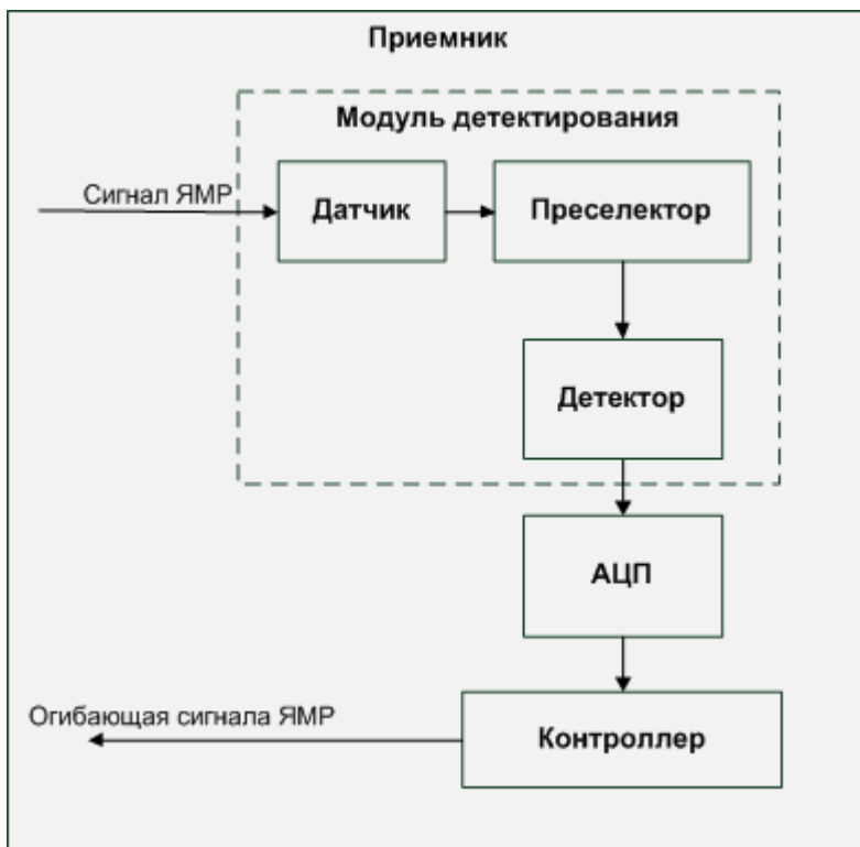
Рис. 1. Структура системы регистрации сигналов ЯМР с детектированием
