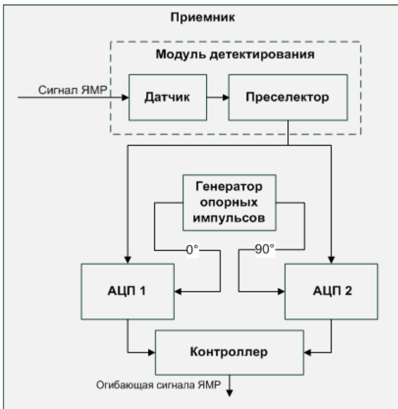
Рис. 3. Структурная схема приемника с цифровым квадратурным детектором огибающей
