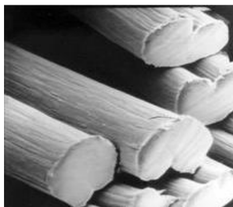
Рисунок 1. Поперечное сечение волокна и его поверхность под электронным микроскопом (фото авторов)
